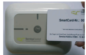
Abb.: Lesevorgang einer SmartCard (RFID-Mitarbeiterausweis) mit dem SC MileStone static
