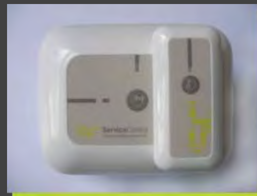
SC MileStone static/GSM zum kabellosen Datentransfer
