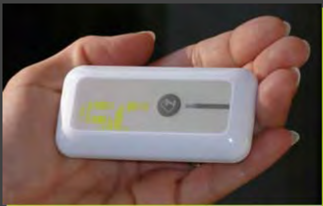
SC MileStone mobile: RFID- und Barcodescanner im handlichen Miniformat
